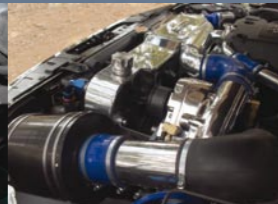
Rob Green Navara-ombouing bestaan uit Vortech drukaanjaer, versterkte vering en verrigtingsuitlaat. Besonderhede oor ombouings by: www.rgmotorsport.com
